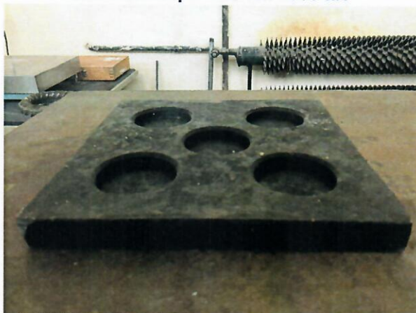
stav vzorku po zatížení 1000 kN
