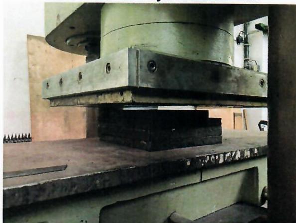
osazení vzorku v hydraulickém lisu
