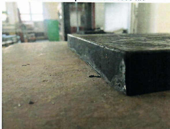
stav vzorku po zatížení 1000 kN
