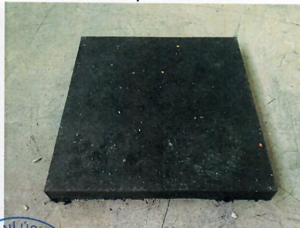
stav vzorku po zatížení 400 kN
